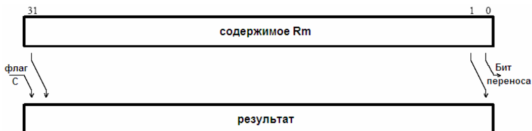
Рисунок 1.7 – Расширенный циклический сдвиг вправо
