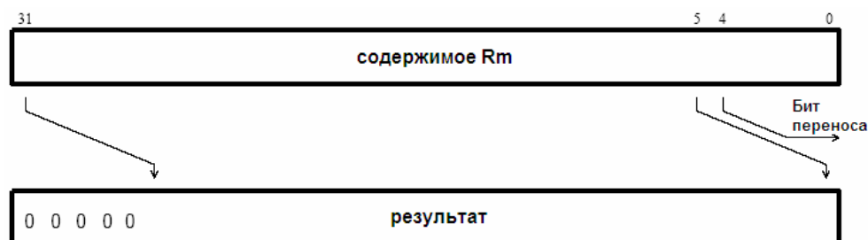
Рисунок 1.3 – Логический сдвиг влево
