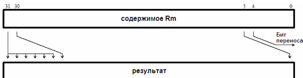
Рисунок 1.5 – Арифметический сдвиг вправо
