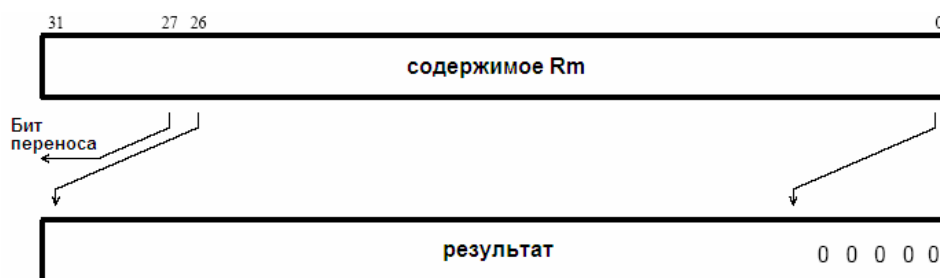
Рисунок 1.4 – Логический сдвиг вправо
